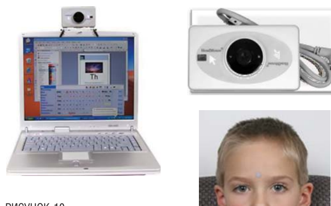
РИСУНОК 10 УСТАНОВЛЕННАЯ НА МОНИТРЕ ГОЛОВНАЯ МЫШЬ. УСТРОЙСТВО «ГОЛОВНАЯ МЫШЬ». СВЕТООТРАЖАЮЩИЙ ЭЛЕМЕНТ НА ЛБУ У РЕБЕНКА
