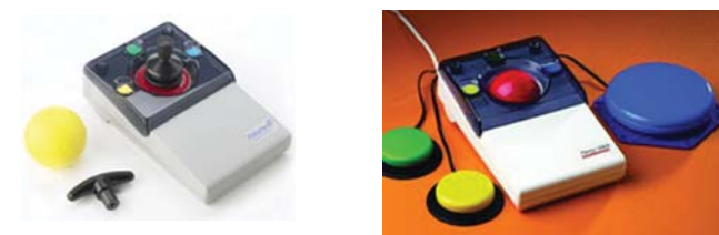
РИСУНОК 8 ДЖОЙСТИК С КОМПЛЕКТОМ НАСАДОК ДЛЯ РАЗНЫХ ТИПОВ ХВАТОВ И РОЛЛЕР С ВЫНОСНЫМИ КОМПЬЮТЕРНЫМИ КНОПКАМИ
